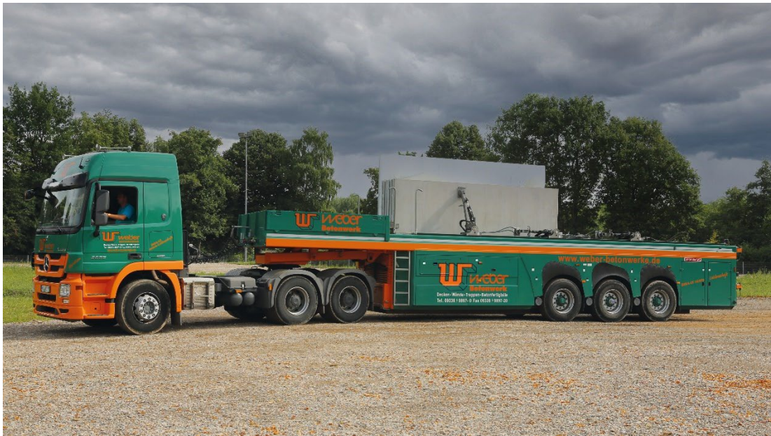
Bild 2: Ein mit Beton-Fertigteilelementen beladener Betoninnenlader
